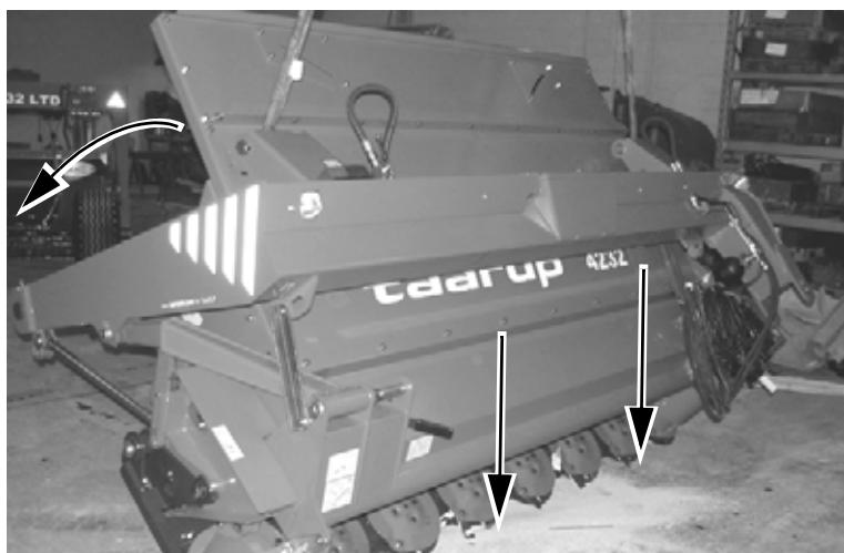
Осторожно поднимите машину с поддона и поставьте ее на почву. Отсоедините подъемное оборудование.
