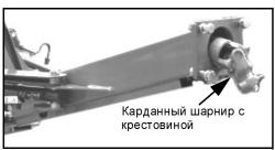
Средняя соединительная балка монтируется к заднему валкообразователю следующим образом:
