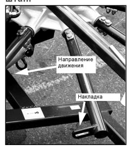
Привинчивание грабельных штанг с использованием содержимого из пакета "А"
